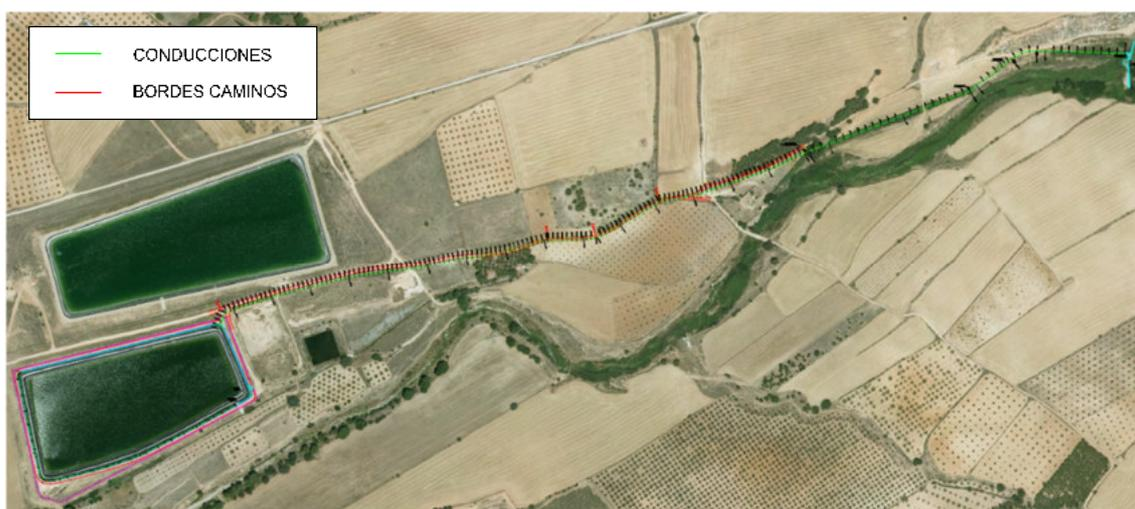
**Figura 25.** Trazado de las conducciones que conectan el azud en el río Vinalopó (derecha) con las balsas existentes (izquierda). **Fuente:** Elaboración propia
