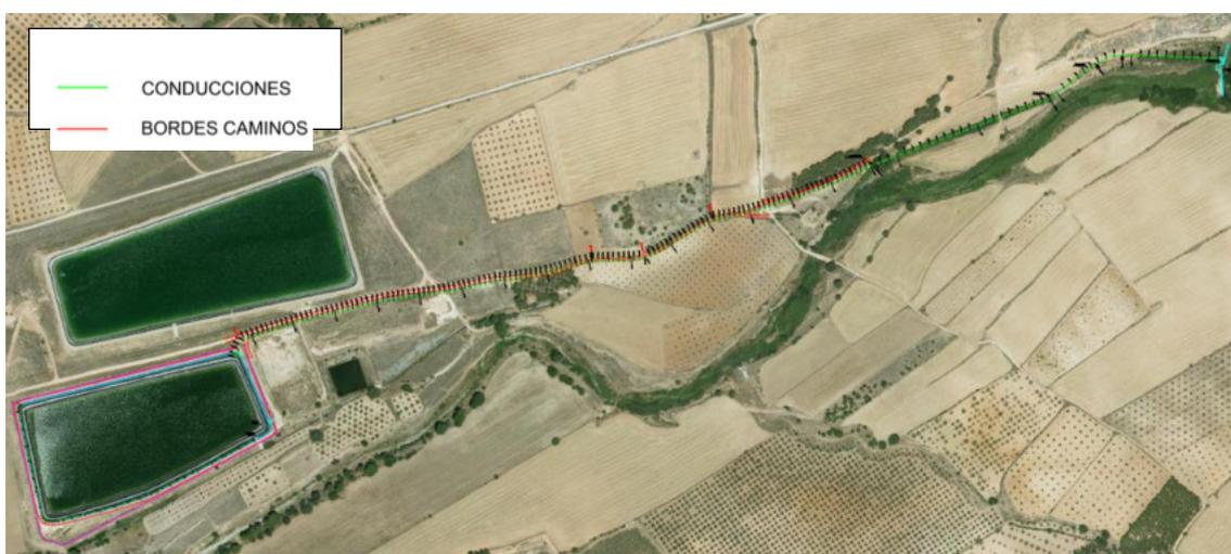
**Figura 47. Trazado de las conducciones que conectan el azud en el río Vinalopó (derecha) con las balsas existentes (izquierda). Fuente: Elaboración propia**
