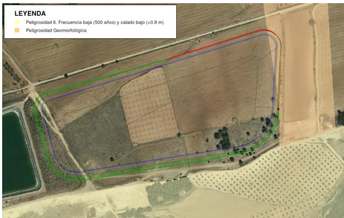
**Figura 9.** Planta de la balsa respecto de la cartografía del PATRICOVA, apreciándose en amarillo la zona de peligrosidad 6 y, en naranja, la zona con peligrosidad geomorfológica. **Fuente:** Elaboración propia.
