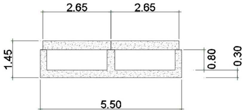
Figura 26. Sección constructiva del aliviadero. Fuente: Elaboración propia.
